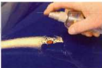
Etwas Alkohol, und der Kleber lässt sich spurlos vom Lack abziehen
