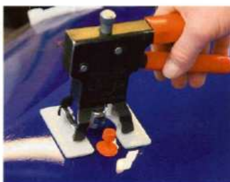
Der Mini-Lifter wird so über den Pin geschoben, dass das dicke Ende locker einrastet
