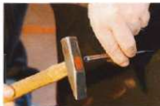
Mit einem simplen Stahldorn klopft Schröder die Beule zurück
