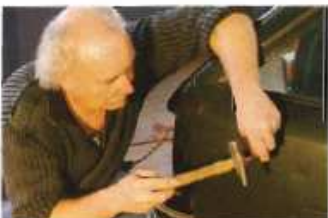
Die letzte Korrektur erfolgt in Gegenrichtung von der Außenseite
