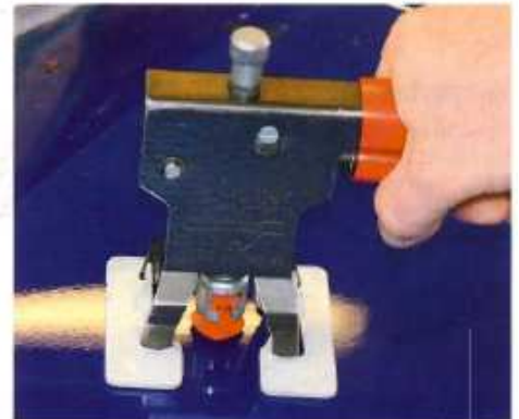
Durch den Zug wandelt sich die Delle zur Beule. Dabei wird das Bleche abermals gestaucht
