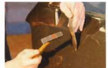
...bevor er mit dem „Löffel“ noch ein paar Unebenheiten begradigt
