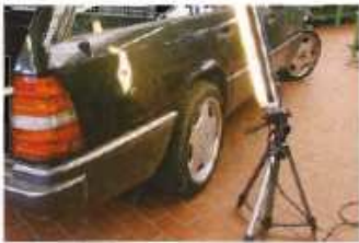
Ins rechte Licht gesetzt: Röhren sind ideal, um Dellen sichtbar zu machen
