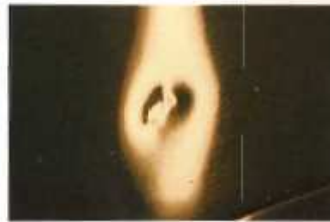
Rund um die Delle wird der Reflex breiter, der Schaden hervorgehoben
