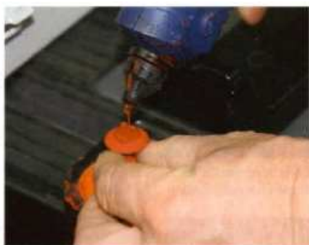
Dazu lässt Schröder zunächst etwas Heißkleber auf einen speziellen Kunststoffpin laufen
